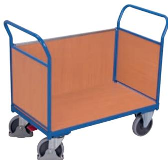
Conception modulaire; châssis avec profilé L innovant; plateau mélaminé; finition hêtre; revêtement époxy bleu RAL 5010; résistant aux chocs et aux rayures; roues à bandage en caoutchouc thermoplastique gris anti-traces avec jante en plastique et roulement à billes de précision, protège-pieds et protection contre l'effilochement, 2 roulettes pivotantes avec frein **EasySTOP** et 2 roulettes fixes.
